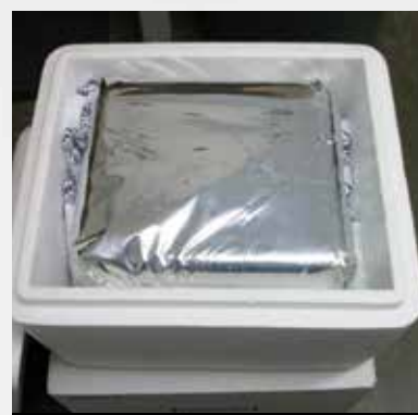
6. 包裹好的内层泡沫箱放置在外层的泡沫箱内，并放置些胶体袋(根据季节需要调整胶体袋的温度)。
