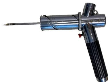
图1.3 用于测定背膘厚度的内腔检测仪
