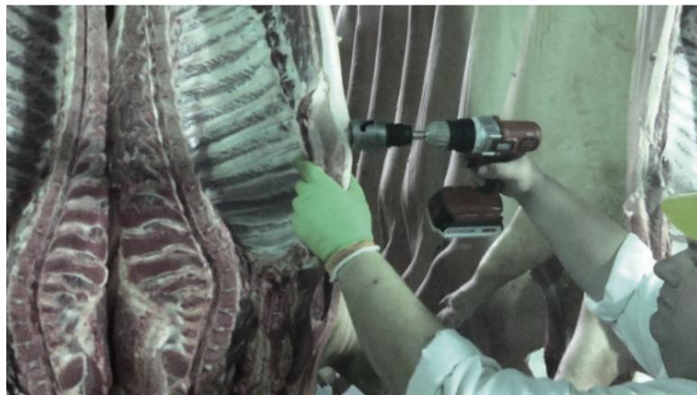
图4.1 安装在钻头上采集脂肪样本的取芯器
