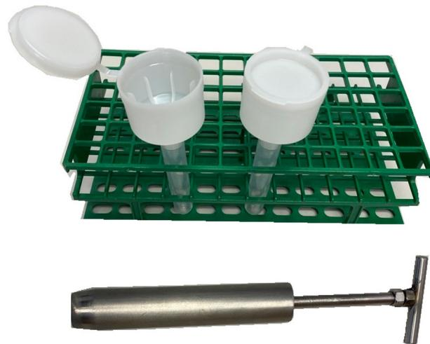
图3.9 EZ滴漏管和取芯装置
